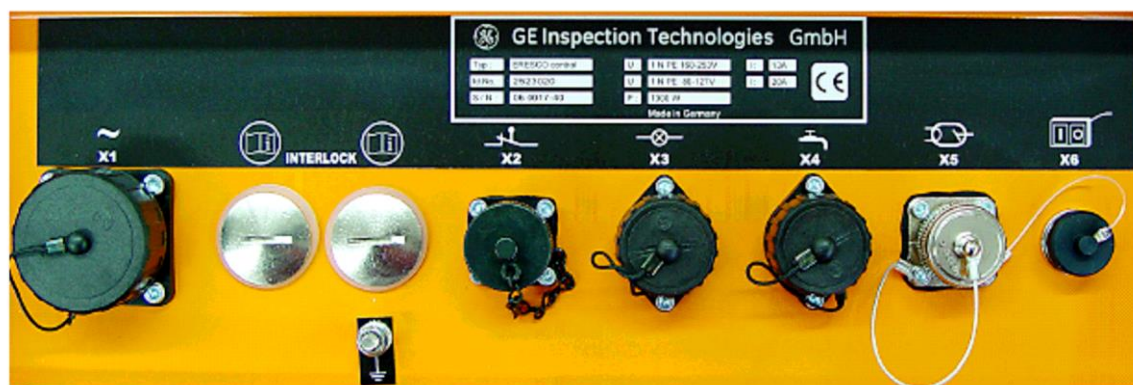
Рис.6 – Задняя панель блока управления ERESCO Control
